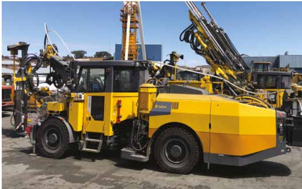
nas operações de furação longa em bancada. Tem capacidade de armazenamento para 775 m de cabo de 15,2 mm e 500 kg de cimento.
