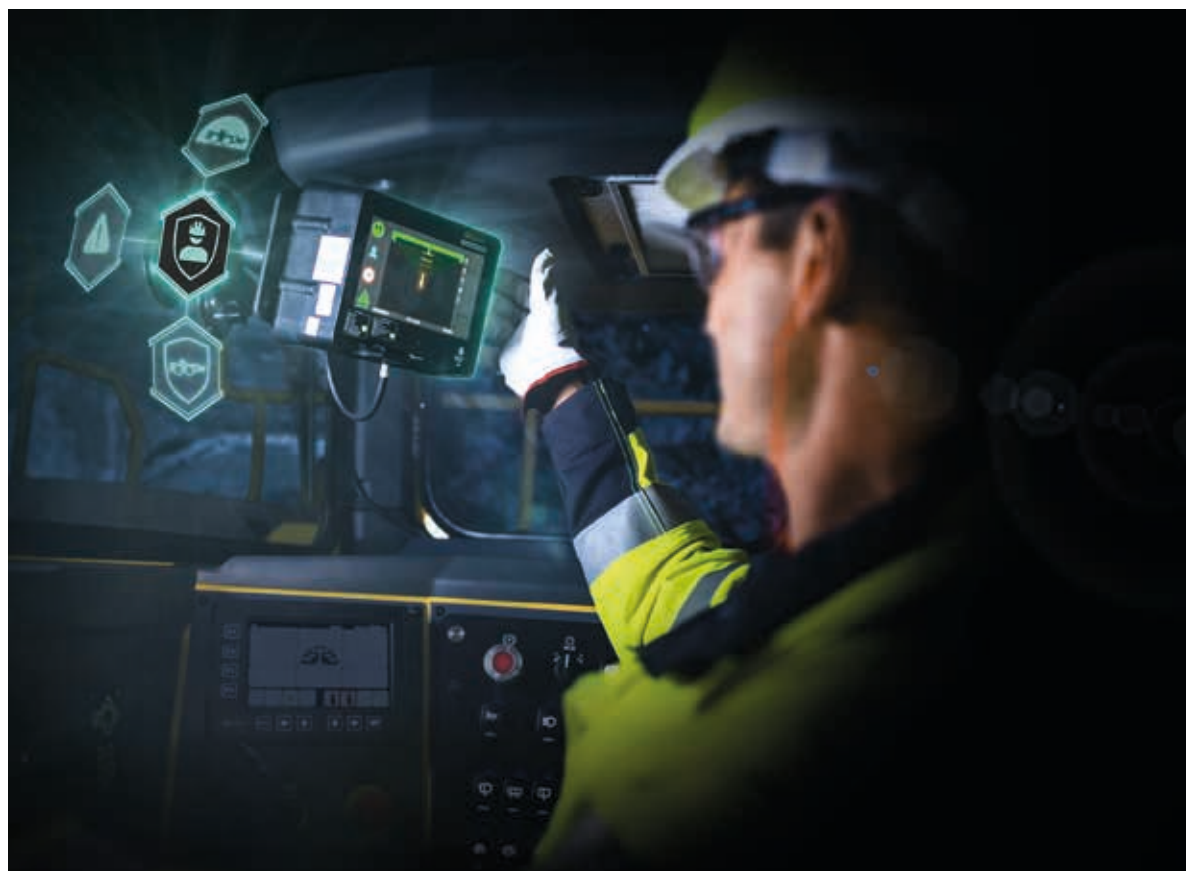
統合されたCAS技術は、衝突しそうになると、レベル7からレベル9までの3つの強度、すなわち警告、行動指示、介入のいずれかで反応します。
